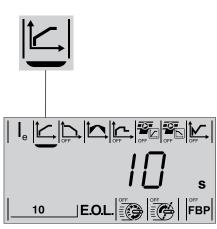
Figure 7.4: Start Ramp Time parameter displayed
