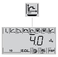
Figure 7.12: Current Limit parameter displayed
