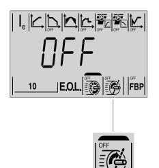
Figure 7.23: Underload Protection parameter displayed
