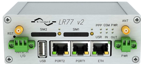
Vollversion im Aluminiumgehäuse mit 2 SIM-Karten und 2 ErweiterungSPORTS
