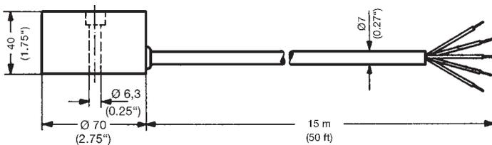
Der Eis- und Schneensensor wird **außerhalb** der beheizten Fläche montiert (siehe Bild 2 und 3 auf S. 16).
